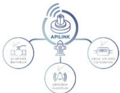
Ces dispositifs de surveillance connectés détectent l'ouverture et la fermeture des poteaux, et calculent les volumes consommés.
